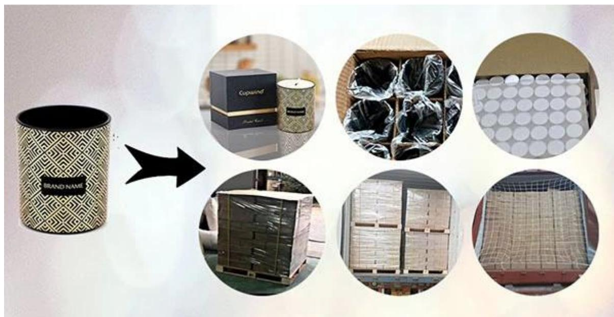
Мы заворачиваем каждое стекло подсвечника в полипропиленовый пакет для защиты от пыли, а затем в гофрированные коробки с поперечными разделителями. Деревянные поддоны всегда эффективны для перевозки LCL, и мы добавим хлопчатобумажную сетку в месте двери, чтобы защитить от падения при открытии двери контейнера..
